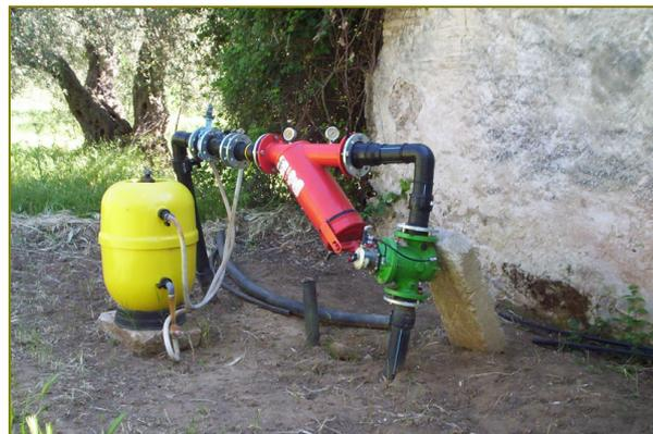
Figura 5. Serbatoio per la distribuzione dei concimi in fertirrigazione.
