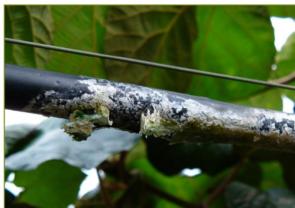
Figura 6. Incrostazione dell'erogatore. L'utilizzo dei concimi quali quali il fosfato-monoammonico (PMA) e il fosfato-biammonico (PDA) con acque d'irrigazione a elevato contenuto di calcio e/o di magnesio può determinare la formazione di precipitati che provocano la occlusione degli erogatori.
